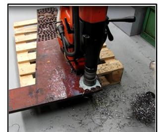
Kernbohren in Hardox 400 mit der KBM 80 auto
